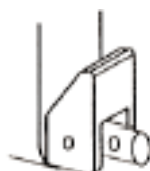
Poloha páky při elektrickém ovládní nebo při ovládní pružinou
